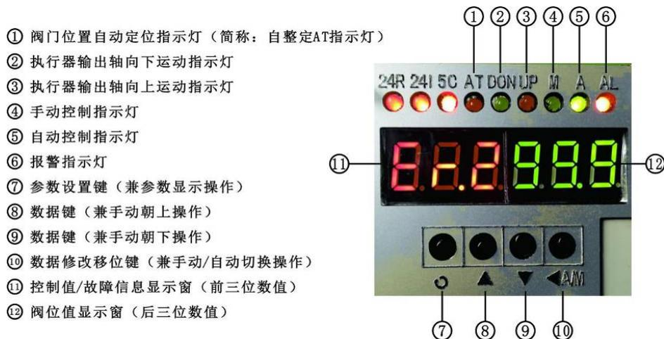
图3 电动调节阀操作面板
