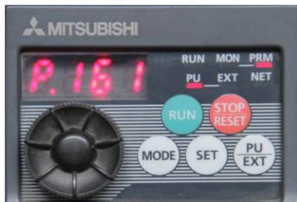
图 18 频率设定/键盘锁定选择设置参数
