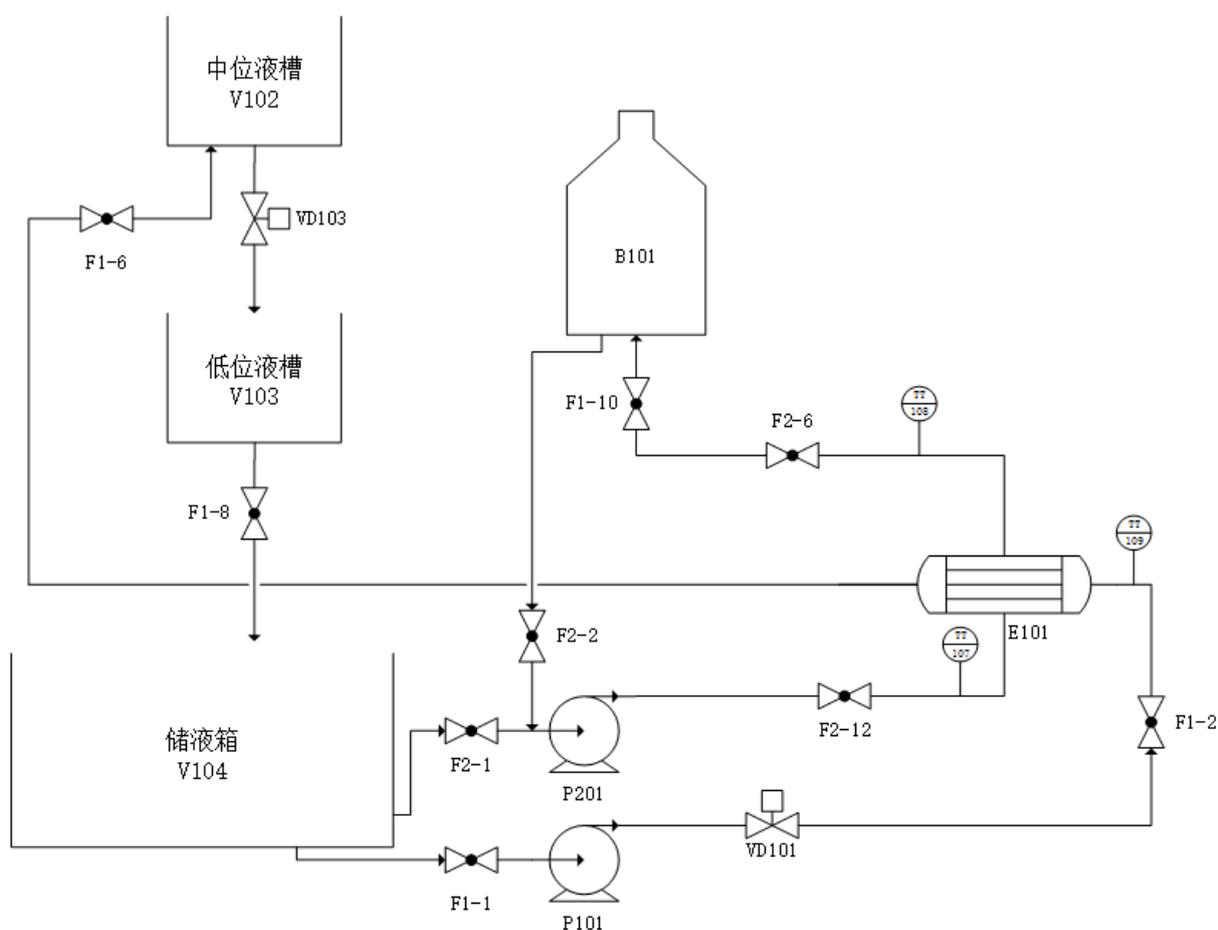
图1 换热器物料液循环换热工艺流程
