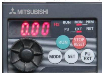
图 9 变频器通电初始状态
